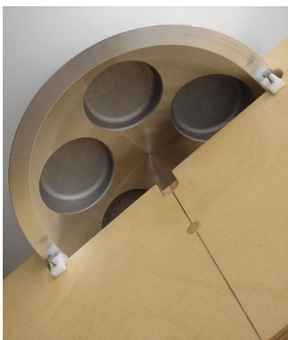
Abb. 9: U-förmige Abstandshalter stützen Höhenräder seitlich ab.
