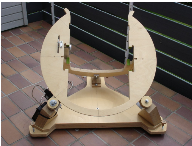
Abb. 5: 2 Holzrollen bilden das Nordlager der Polachse
