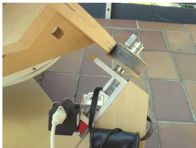
Abb. 10: Die Nachführung mit Getriebe-Schrittmotor, Schneckengetriebe und Antriebsrolle mit Klemmhebel.
