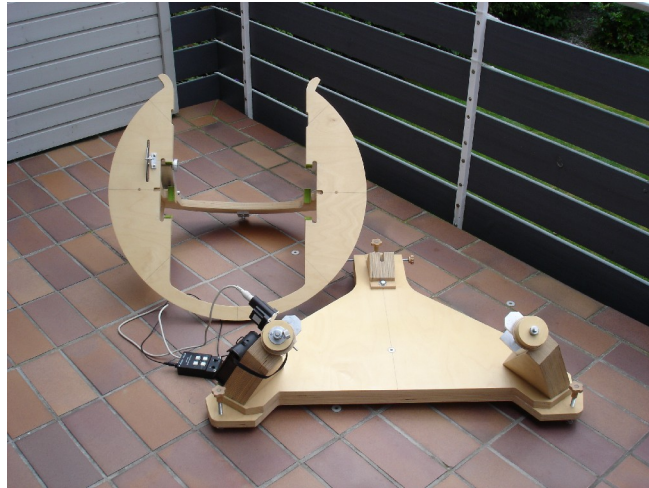
Abb. 4: Die Montierung ohne Werkzeug in 2 Teile zerlegt
